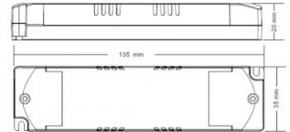
**Dimmbarer DALI-Treiber DT6 einfarbig 220-240V - Ausgang 6-42V DC - 100-700 mA - 12W**
