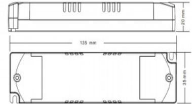
**Dimmbarer DALI-Treiber DT6 einfarbig 220-240V - Ausgang 6-42V DC - 100-70 0 mA - 15W**
