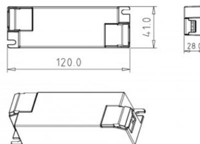
**Dimmbarer DALI-Treiber DT6 einfarbig 220-240V - Ausgang 6-58V DC - 250-700 mA - 25W**
