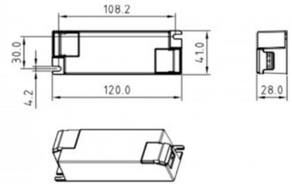
**Dimmbarer DALI Treiber DT8 CCT 220-240V - Ausgang 6-54V DC - 250-700 mA - 25W**
