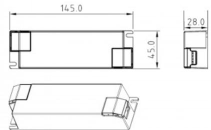
**Dimmbarer DALI-Treiber DT6 einfarbig 220-240V - Ausgang 6-58V DC - 500-1400 mA - 45W**
