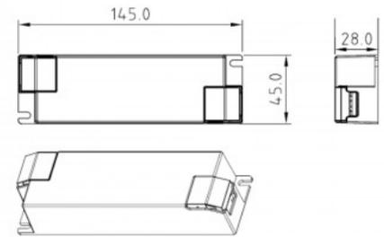
**Dimmbarer DALI Treiber DT8 CCT 220-240V - Ausgang 6-54V DC - 500-1400 m A - 45W**
