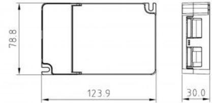
**Dimmbarer DALI Treiber DT8 CCT 220-240V - Ausgang 6-54V DC - 500-1500 mA - 65W**
