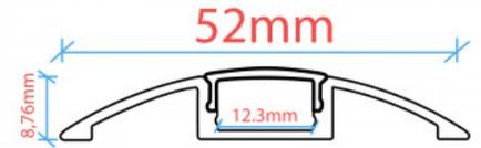
LED-Streifen Bodenprofil Halbmond - Oberfläche - 9x52mm - Mit Diffusor - 2 Meter
