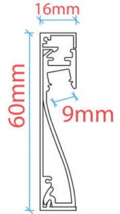
**Profilo a strisce LED per battiscopa - 60x16 mm - Con diffusore - 2 metri**
