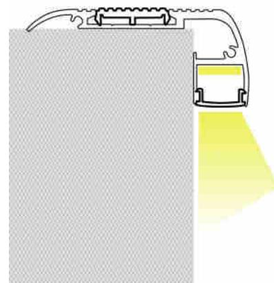
**Profilo a striscia LED per scale - 27x63mm - Con diffusore - 2 metri**
