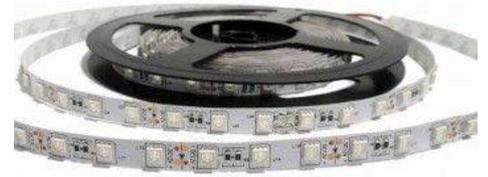
Fita de LED 12V-DC 72W 10mm monocor IP20 (SMD5050 60ch/m) Rolo 5 metros
