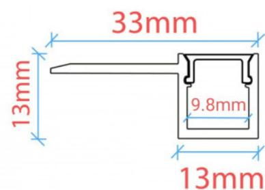
Fita LED de integração de perfil / sem remate - Uma alheta - 10x13mm - Com difusor - 2 metros
